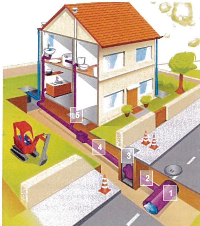
**Schéma de principe d'un branchement**
